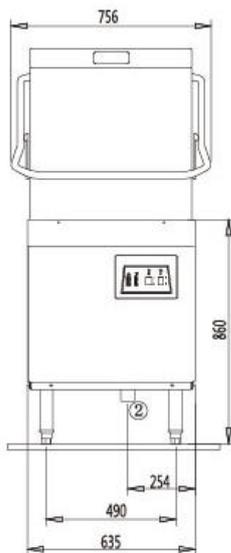
ITEM 2: DRENO DE ESCOAMENTO (ESGOTO) A NÍVEL DO PISO
